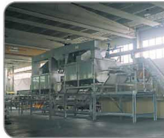
20/22- Gruppo di preessiccazione e stabilizzazione 20/22- Pre-drying and stabilizing unit
