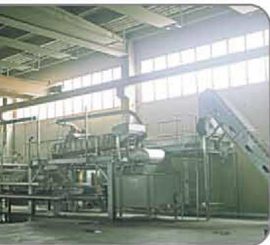
01/15: Gruppo di preriscaldamento, taglio, calibratura e cernita ottica 01/15: Preheating, cutting, sizing and optical sorting unit
