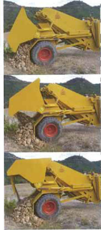
Despedregadora descargando al suelo Rock Picker unloading to ground Déchargement du épierreuse au sol
