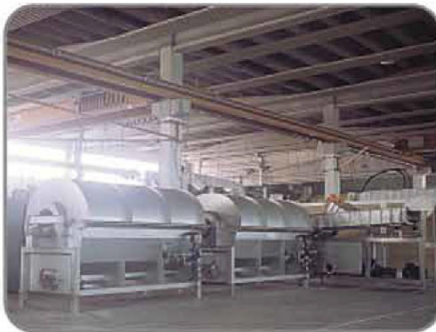
17/18- Gruppo di blancheratura per scioglimento zuccheri e gelatinizzazione amido 17/18- Blanching unit to dissolve sugar and gelatinize starch
