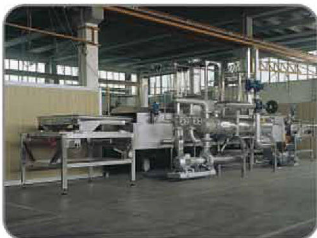
23/25- Friggitorie con piano vibrante di alimentazione e piano vibrante di sgranatura 23/25- Fryer with feeding vibrating table and vibrating table for oil dripping
