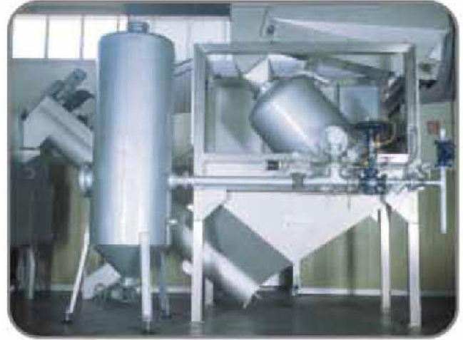
06- Pelatore a pressione di vapore 06- Pressure steam peeler
